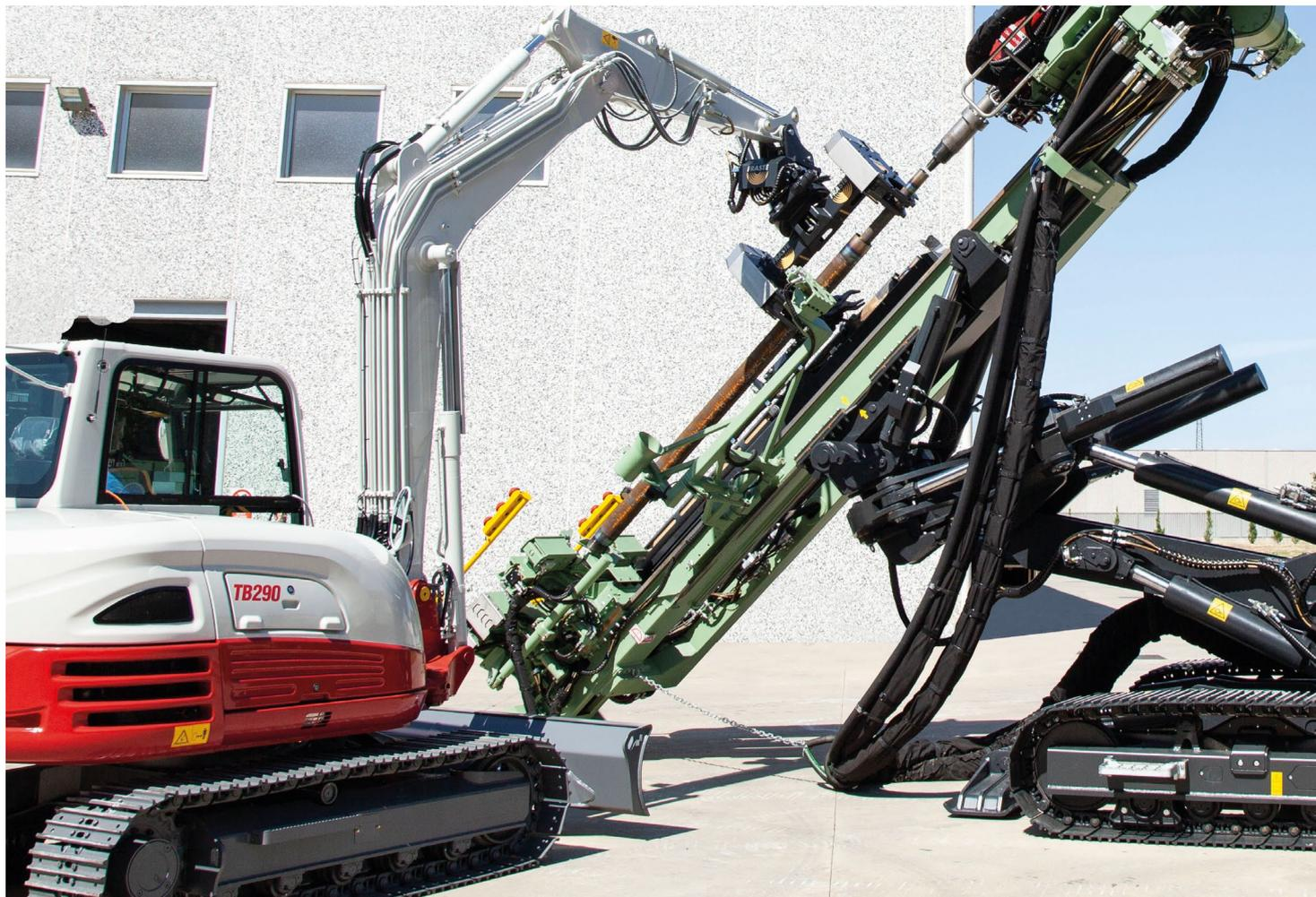
Questo semplice, forte e sicuro **dispositivo idraulico**, espressamente progettato per essere montato sul braccio dell'escavatore può maneggiare aste e casing di diametri diversi, agevolando sensibilmente il caricamento durante la perforazione; ma la sua caratteristica prima è quella di evitare la rimozione manuale delle aste e dei casing, il che significa un **sensibile incremento della sicurezza per gli operatori!**
