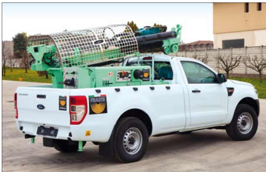
La macchina perforatrice Hyndaga, montata su pick-up
