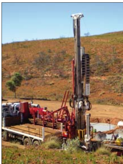
La macchina perforatrice FS 400, ideale per la trivellazione di pozzi acquiferi, ricerca mineraria, sismica e geotermia
