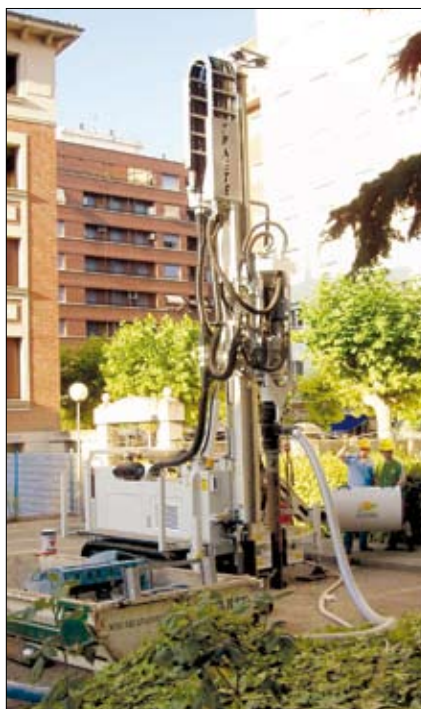
Il modello Multidrill XL-DR è impiegato per la perforazione ad aria in ambito geotermico
