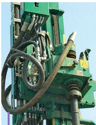
**La testa di rotazione a quattro velocità. Per questa macchina è stato adottato un circuito idraulico particolare comprendente una classica pompa in circuito aperto adibita alle funzioni di perforazione e una seconda pompa in circuito chiuso (da 95 l/min. e 280 bar di pressione) dedicata esclusivamente al funzionamento della testa di rotazione.**
