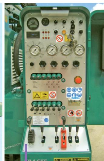
**Il pannello di comando della Multidrill ML. Come spesso accade per gli interventi geognostici, in luogo dei joystick elettrici Fraste ha installato un pannello di comando completamente idraulico.**
