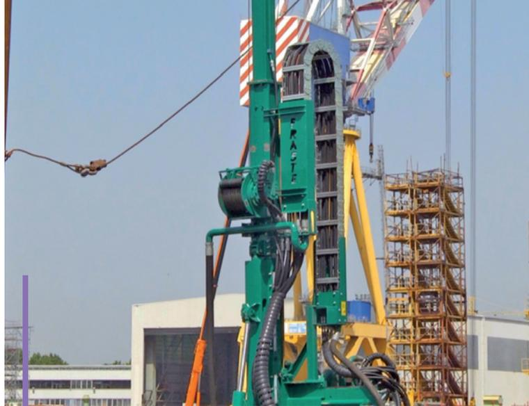
**La macchina è anche stata equipaggiata con un argano Wire Line molto veloce (100 m/min.) giustificato dallo specifico impiego che necessita di rapide estrazioni e reintroduzioni nel foro del carotiere.**
