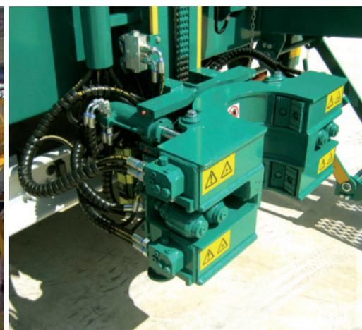
**La doppia morsa oleodinamica (40-240 mm) in dotazione alla Multidrill ML**
